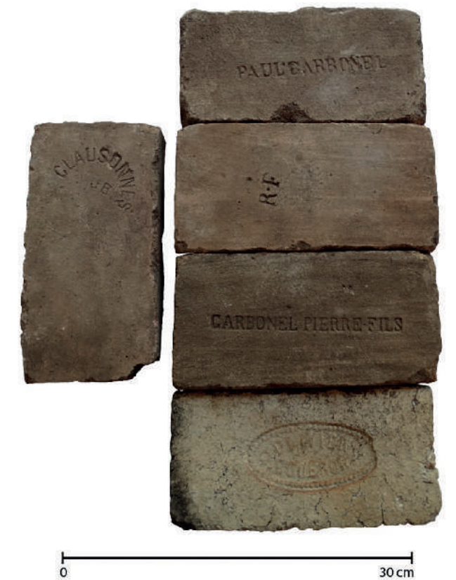
[Fig. 8]: Échantillon de briques réfractaires découvertes lors de la campagne de 2016 (photo J.-F. Rebeyrotte / service régional de l'inventaire / association Domaine de La Roseraie)
